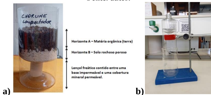
Figura 6 – a) Dispositivo de simulação de lençol freático, escala da imagem 1:3,8 cm; b) Dispositivo de fluxo de adsorção, escala da imagem 1:8,25 cm.
