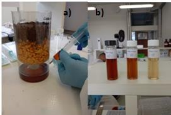
Figura 12 – a) Coleta de amostra com seringa em dispositivo de simulação de lençol freático; b) Armazenamento das amostras percoladas.
