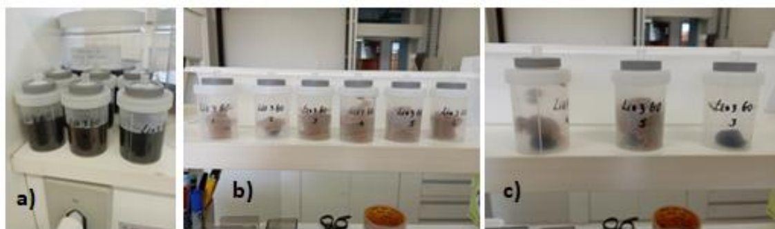
Figura 22 – a) Amostras de GO para liofilização com tampa de filtrilo de seringa; b) Amostras de GO após a liofilização apresentando volume expandido com estrutura de esponja; c) Amostras de GO com o volume sendo adensado e apresentando estrutura esponjosa e a cor escura característica.
