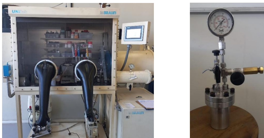
Figura 11 – Caixa seca e autoclave utilizados na reação de hidrogenação de éster
