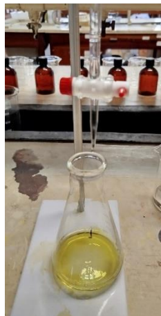
Figura 3.2 – Montagem da titulação de determinação do teor de Na 2 O
