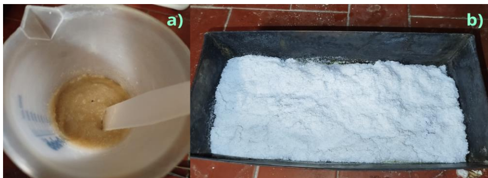
Figura 3.1 – Etapas de produção de silicato de sódio. a) pasta obtida na mistura de areia, hidróxido de sódio e água; b) silicato de sódio obtido
