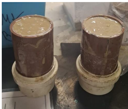
Figura 3.3 – Corpos de prova durante o processo de cura
