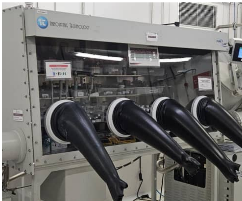
Figura 17 – Equipamento utilizado no preparo das formulações ( Glove box )
