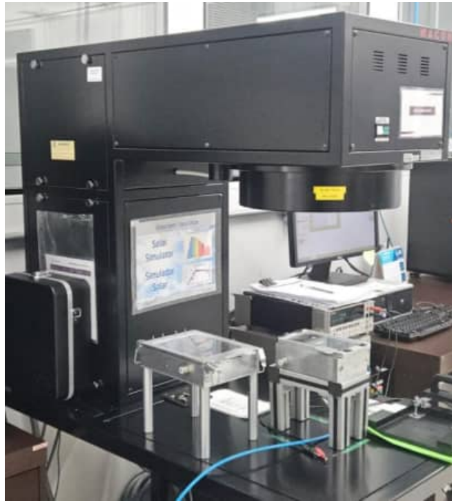
Figura 22 - Simulador solar utilizado na caracterização elétrica dos dispositivos
