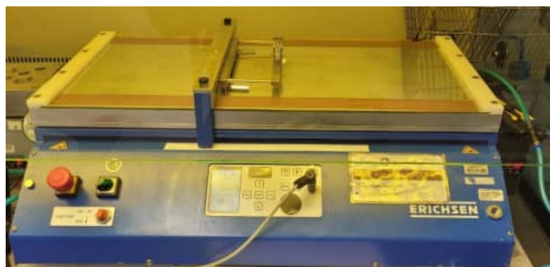
Figura 20 - Blade coater utilizado para a deposição da camada de ETL
